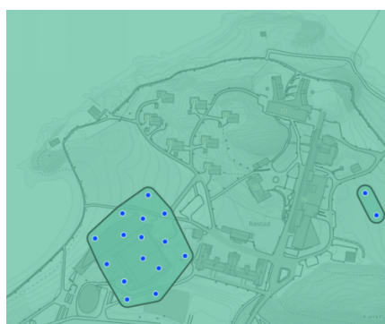
Figur 19: NGUs kart viser at det er gjort grunnundersøkelser på campus, men ikke tett på aktuell tomt. Blå prikker er borehull.
