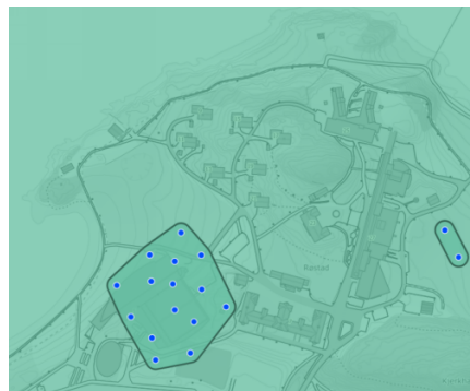
Figur 7: NGUs kart viser at det er gjort grunnundersøkelser på campus, men ikke tett på aktuell tomt. Blå prikker er borehull.
